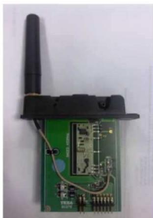
Рис. 1 - радио модуль для устройств серии Konfort 700
