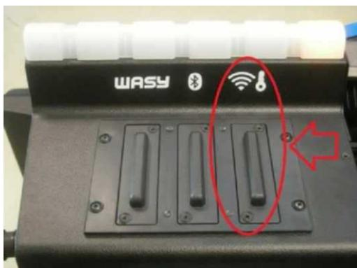
Рис. 3 – расположение радио модуля комплекта проверки эффективности климат-контроля
