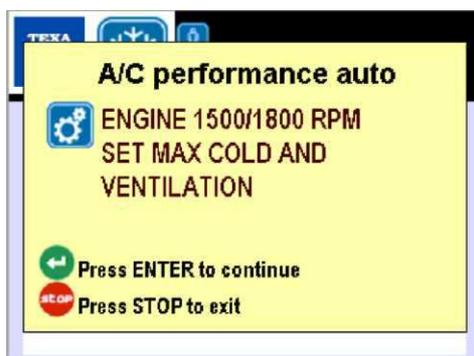
Рис. 13 – просьба увеличить обороты двигателя и установить максимально низкую температуру системы кондиционирования
