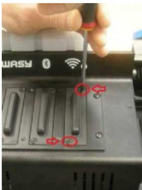
Рис. 4 – снятие винтов с крышки разъема для радио модуля
