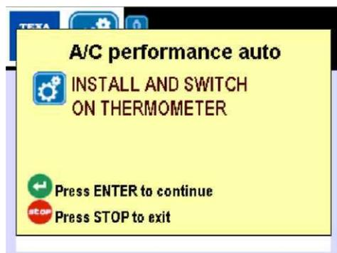
Рис. 10 – запрос о подключении беспроводного термометра к вентилятору системы кондиционирования и его включении.
