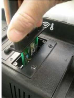
Рис. 6 – установка радио модуля в соответствующий разъем
